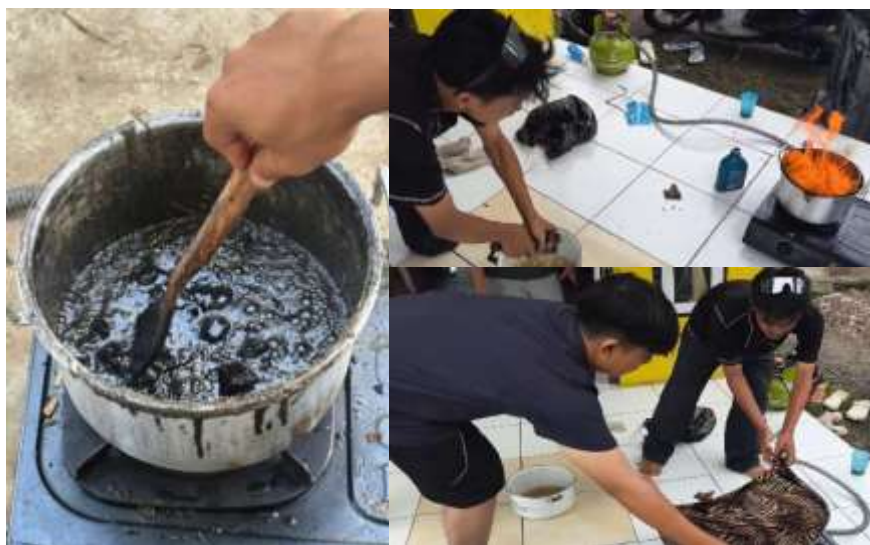
Gambar 3. Peleburan plastik menggunakan oli bekas
