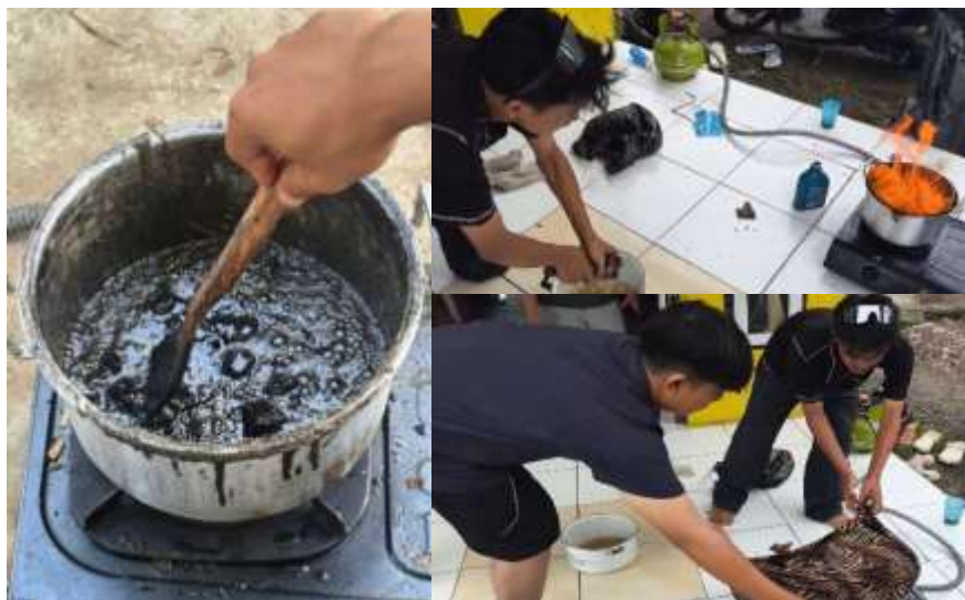
Gambar 3. Peleburan plastik menggunakan oli bekas
